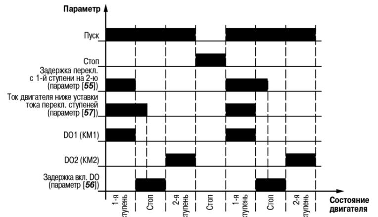
Рисунок 5.2 – Диаграмма работы прибора при двухступенчатом режиме
