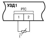
Рисунок 4.7 – Схема подключения PTC-датчика
