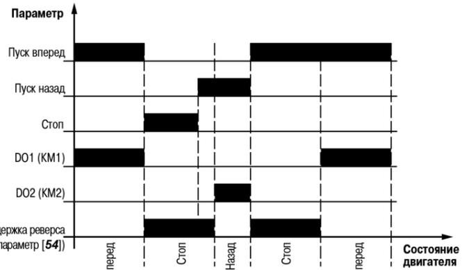
Рисунок 5.1 – Диаграмма работы прибора при реверсивном режиме
