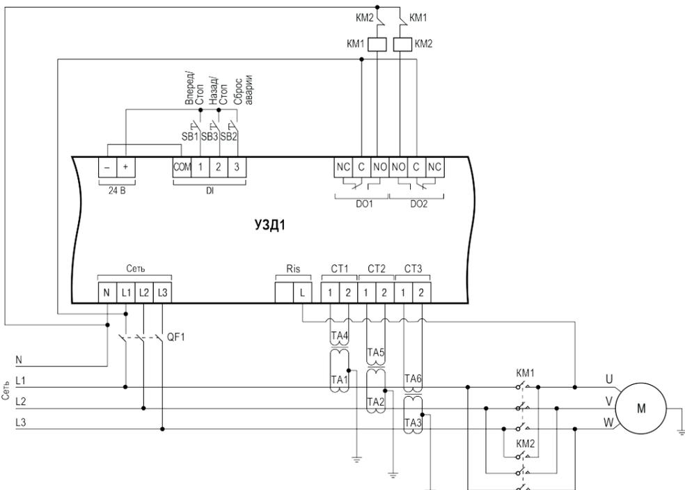
Рисунок 4.1 – Электрическая схема реализации реверсивного режима работы электродвигателя\*\*
