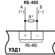
Рисунок 4.6 – Схема подключения интерфейса RS-485
