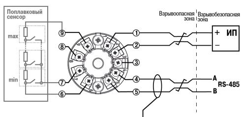
Рисунок 7.3 – Схема подключения с подключением экрана к заземлению
