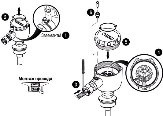
Рисунок 7.1 – Монтаж внешних электрических цепей
