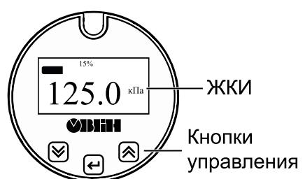
Рисунок 5.5 – Лицевая панель блока индикации
