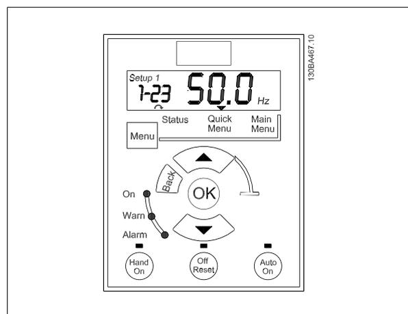
Рисунок 4.2: Панель местного управления LCP 11 без потенциометра
