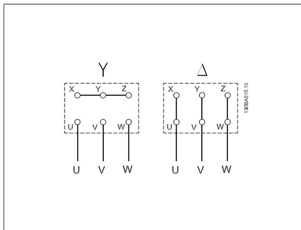
Рисунок 3.3: Соединения по схемам "звезда" и "треугольник".
