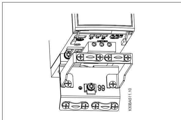
Рисунок 3.5: Привод VLT Micro с развязывающей панелью
