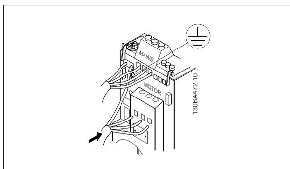
Рисунок 3.4: Подключение заземляющего кабеля и проводов двигателя.
