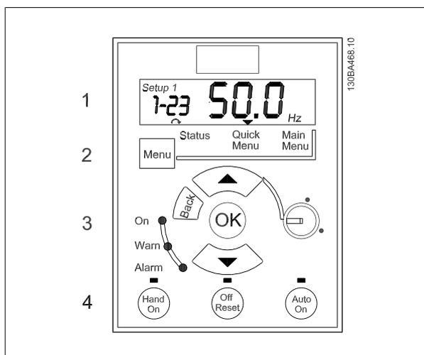
Рисунок 4.1: Панель местного управления LCP 12 с потенциометром
