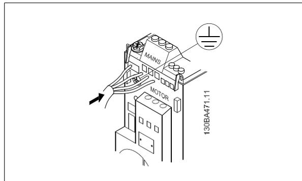
Рисунок 3.1: Подключение заземляющего кабеля и сетевых проводов.
