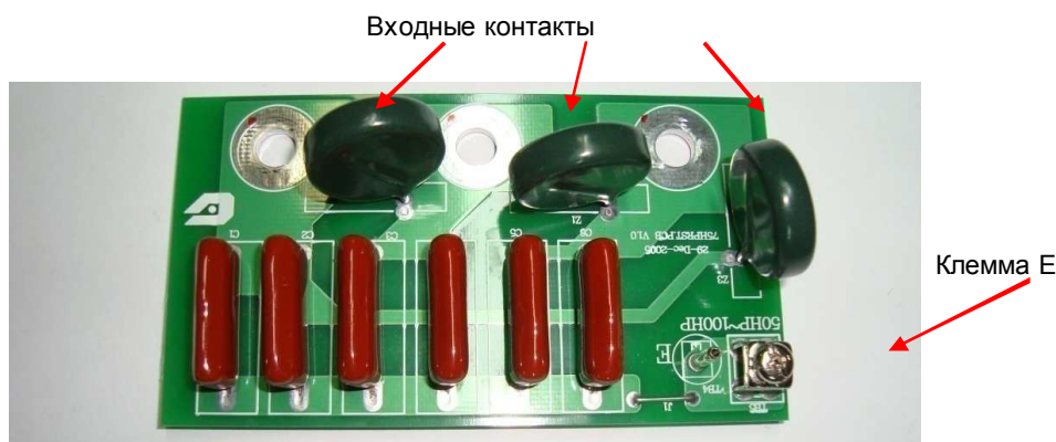
Рис. 4.15. Диагностика платы варисторов
