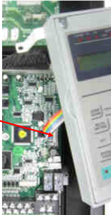
Рис. 7.25. Установка рамки пульта управления.
