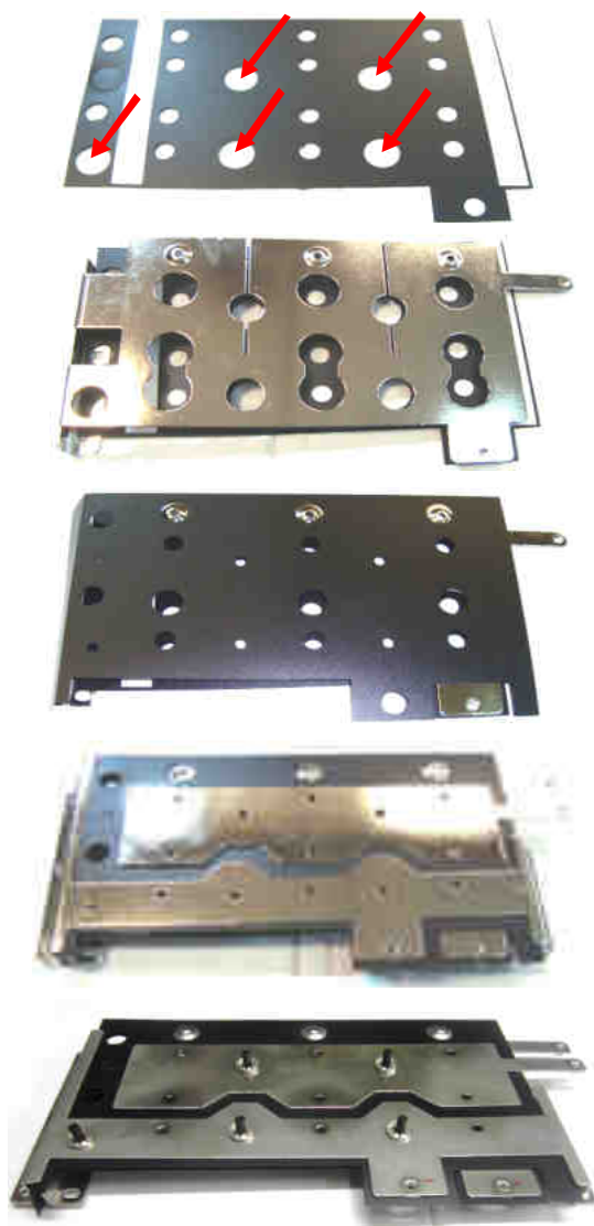
Рис. 7.14. Порядок сбора шин «+» и «-»ЗПТ.
