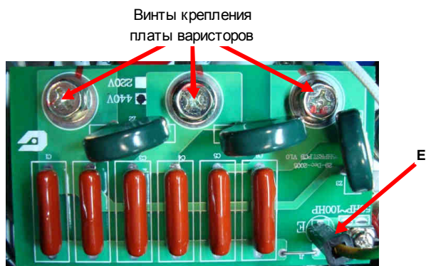
Рис. 7.23. Установка платы в аристоров.
