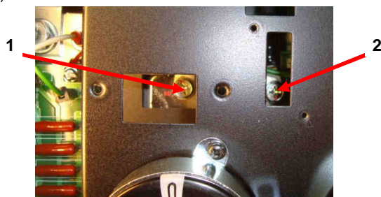
Рис. 7.20. Подключение выводов «+» и «-».
