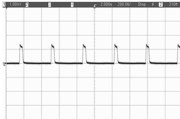
Рис. 4.15. Осциллограмма у правления диодно-тиристорным моду лем (200 мкс/дел).
