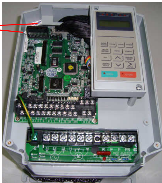
Рис. 8.3. Положение ремонтных гарантийных наклеек.
