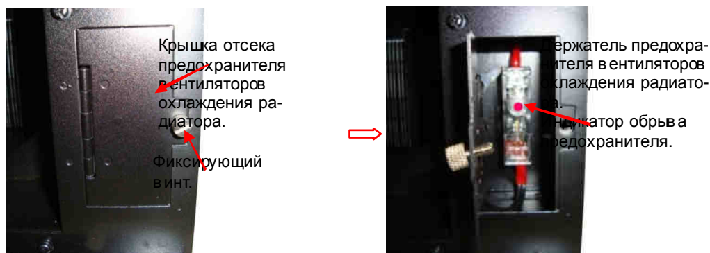
Рис. 4.25. Предохранитель цепи питания вентиляторов охлаждения радиатора
