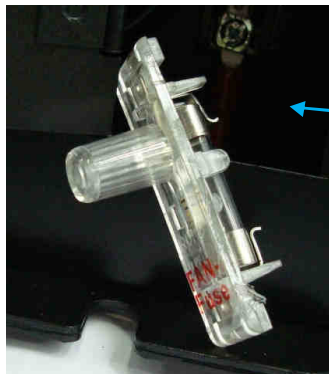
Предохранитель в вентиляторов охлаждения радиатора. Подключение щупов прибора.
