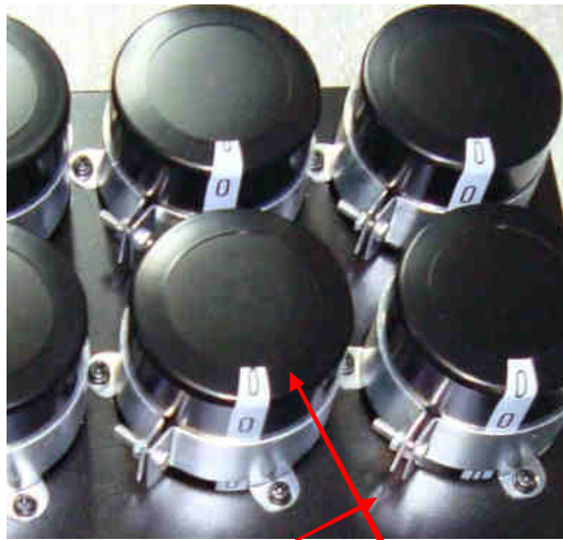
Винты крепления хомутов а)
