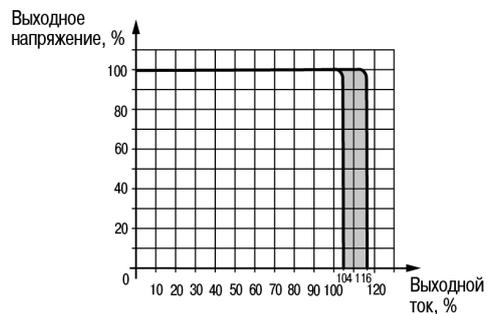
Рисунок 5 - График зависимости выходного напряжения от выходного тока
