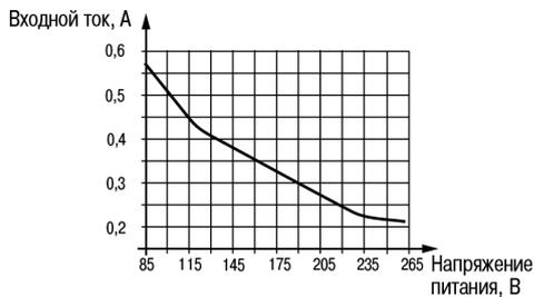
Рисунок 6 - График зависимости входного тока от напряжения питания
